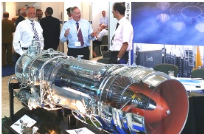
Aufgeschnittene Gasturbine des Typs ROLLS ROYCE KB5 an der Zellchemie-Ausstellung in Wiesbaden
